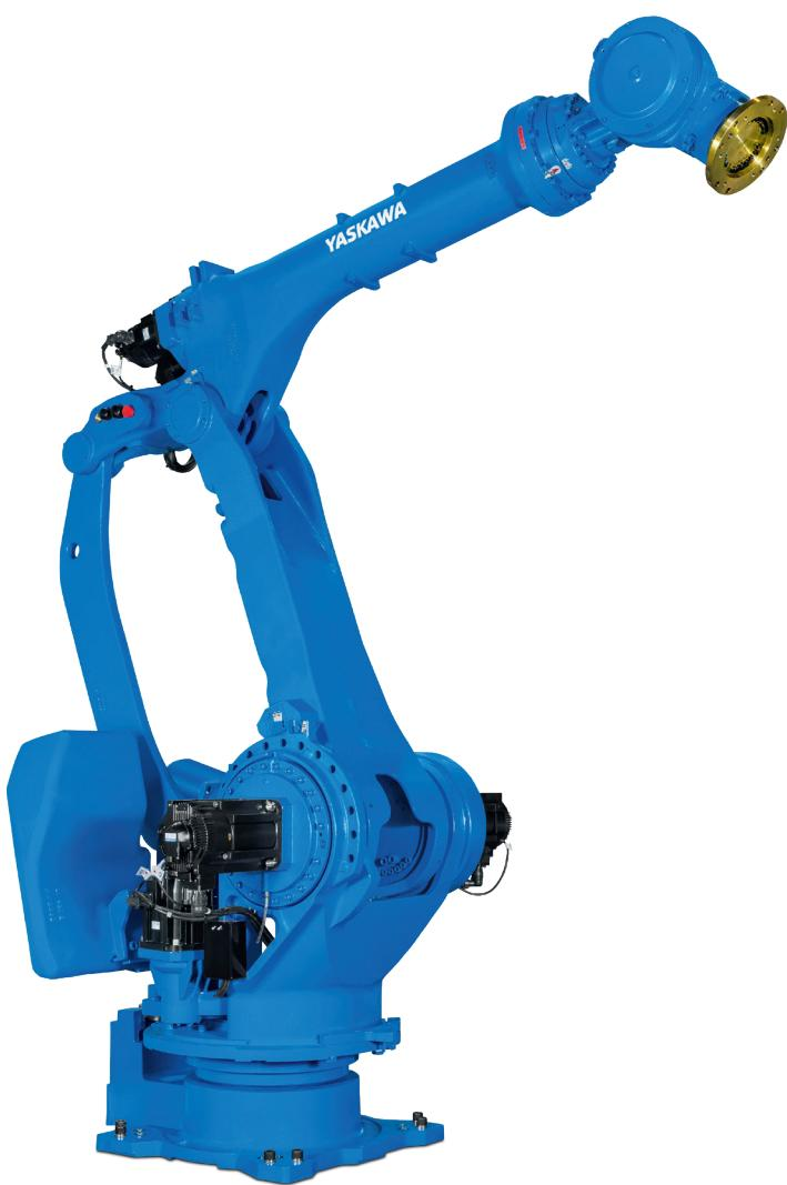
Der 6-achsige Roboter MOTOMAN GP280L ist ein leistungsstarker und vielseitiger Industrieroboter, der sich ideal für eine Vielzahl von Anwendungen eignet. Er zeichnet sich durch eine hohe Traglast von 280 kg und einen großen Arbeitsbereich aus.
