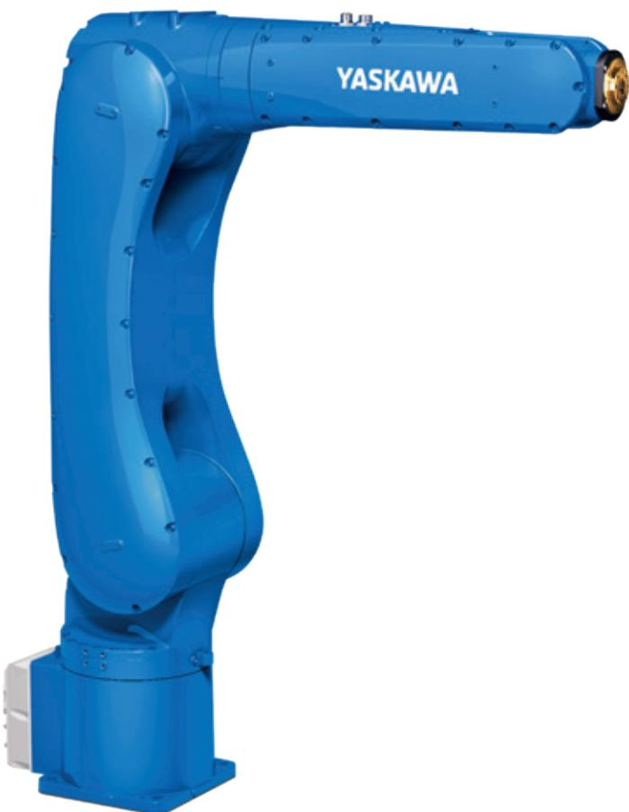
Der MOTOMAN GP10 ist ein schneller und äußerst präziser 6-Achsen-Industrieroboter mit einer Tragkraft von bis zu 10 kg. Mit einer Reichweite von 1.101 mm und einer sehr hohen Wiederholgenauigkeit von  $\pm 0,015$  mm eignet er sich ideal für Montageaufgaben, aber auch für universelle Handhabungsaufgaben, die Beschickung von CNC-Werkzeugmaschinen oder Verpackungsaufgaben. Sein modernes und schlankes Industriedesign minimiert den Platzbedarf am Einbauort.
