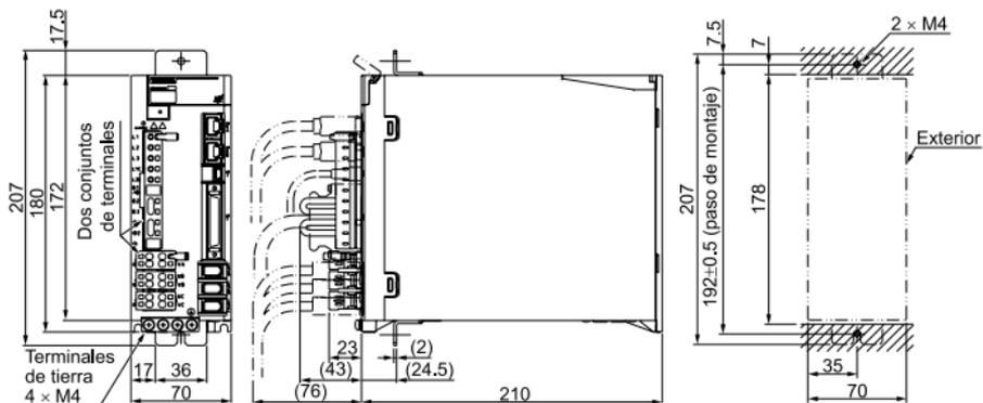
Diagrama de orificios de montaje
