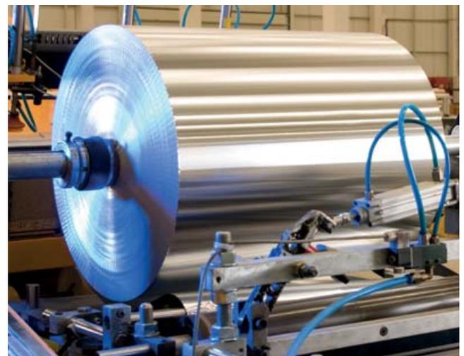
In der Version für Wickler erfüllen unsere Frequenzumrichter die speziellen Anforderungen von Auf- und Abwickelsystemen. Asynchron- und Permanentmagnetmotoren lassen sich mit oder ohne Drehzahlgeber regeln und ermöglichen präzises Wickeln von Textilien, Papier, Folien, Drähten etc.
