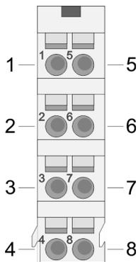
Für Drähte mit einem Querschnitt von 0,08mm<sup>2</sup> bis 1,5mm<sup>2</sup>.
