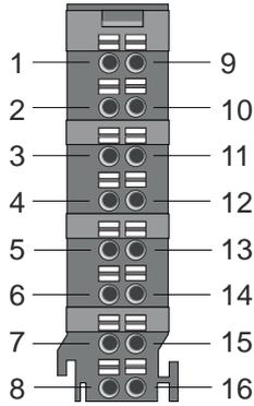
Für Drähte mit einem Querschnitt von 0,14mm<sup>2</sup> bis 0,75mm<sup>2</sup>. Bei einem Querschnitt < 0,25mm<sup>2</sup> sind Aderendhülsen zu verwenden. *"Daten"...Seite 32*
