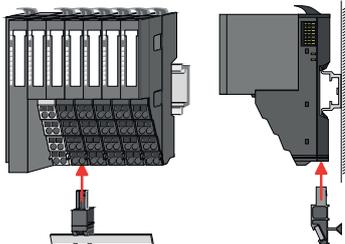
Der Schirmschienen-Träger (Best.-Nr.: 000-0AB00) dient zur Aufnahme von Schirmschienen (10mm x 3mm) für den Anschluss von Kabelschirmen. Schirmschienen-Träger, Schirmschiene und Kabelschirmbefestigungen sind nicht im Lieferumfang enthalten, sondern ausschließlich als Zubehör erhältlich. Der Schirmschienen-Träger wird unterhalb des Klemmblocks in das Terminal-Modul gesteckt. Bei flacher Profilschiene können Sie zur Adaption die Abstandshalter am Schirmschienen-Träger abbrechen.
