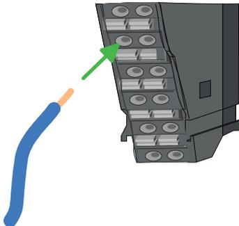
1. Ermitteln Sie gemäß der Gehäusebeschriftung die Anschlussposition.
