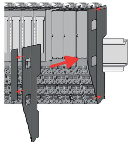
7. → Nachdem Sie Ihr Gesamt-System montiert haben, müssen Sie zum Schutz der Bus-Kontakte die Bus-Blende am äußersten Modul wieder stecken. Handelt es sich bei dem äußersten Modul um ein Klemmen-Modul, so ist zur Adaption der obere Teil der Bus-Blende abzubrechen.
