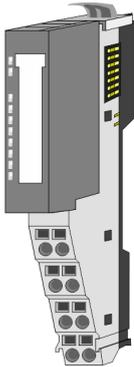
Die Spannungsversorgung erfolgt im System SLIO über Power-Module. Diese sind entweder im Kopf-Modul integriert oder können zwischen die Peripherie-Module gesteckt werden. Je nach Power-Modul können Sie Potenzialgruppen der DC 24V Leistungsversorgung definieren bzw. die Elektronikversorgung um 2A erweitern. Zur besseren Erkennung sind die Power-Module farblich von den Peripherie-Modulen abgesetzt.
