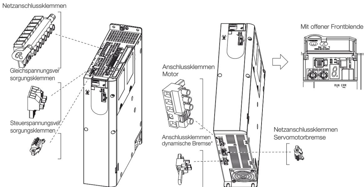
\* Dynamischer Bremsanschluss nur für SGD7S-1R9D bis -170D.
