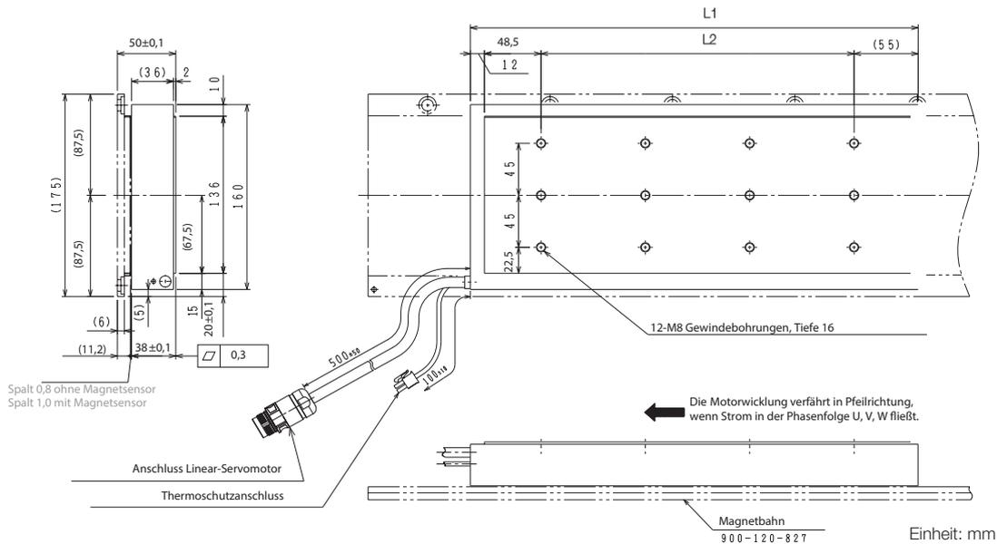
Die Steckerspezifikationen für Sensorkabel und Servomotor-Hauptstromkabel bzw. für Motorwicklung mit Polaritätssensoren entnehmen Sie bitte dem folgenden Abschnitt: SGLFW2-90 und -1D.
