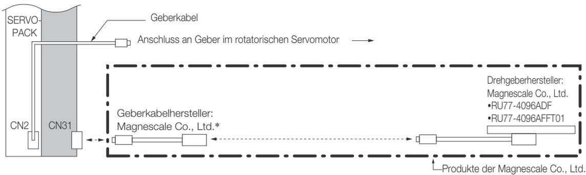
\* Zum Anschluss von SERVOPACK und Drehwertgeber RU77 Verlängerungskabel der Serie CE28 vom Hersteller Magnescale Co., Ltd. verwenden.
