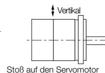
\*3 Die Tabelle oben zeigt die Vibrationsfestigkeit in Längs-, Quer- und Höhenrichtung bei Montage des Servomotors mit horizontaler Ausrichtung der Welle. Die Stärke der Schwingungen, denen der Servomotor standhalten kann, ist abhängig von der Anwendung. Überprüfen Sie die Schwingungsbeschleunigungsrate, die auf den installierten Servomotor wirkt.
