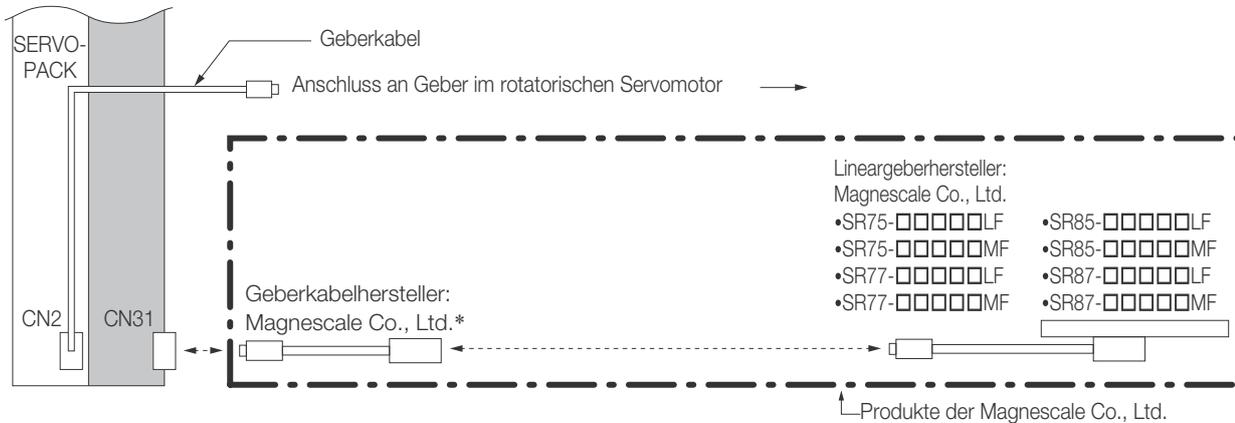
\* Zum Anschluss von SERVOPACK und Linear-Geber Kabel CH33-xx□□G vom Hersteller Magnescale Co., Ltd. verwenden (dieses Kabel besitzt Anschlüsse, die für die Verwendung mit Yaskawa-Produkten ausgelegt sind).
