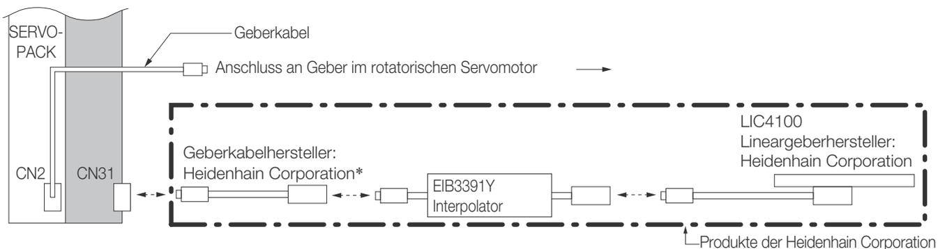
\* Geberkabel vom Hersteller Heidenhain Corporation verwenden. Detaillierte Spezifikationen der Geberkabel erfragen Sie bitte bei der Heidenhain Corporation.
