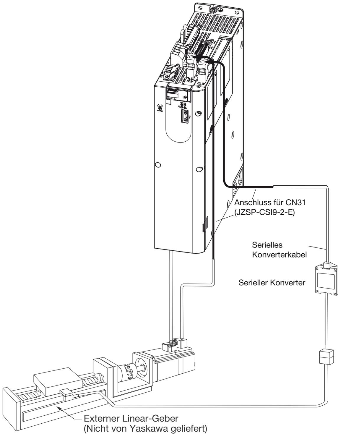
\* Die angeschlossenen Geräte und Kabel sind abhängig vom Typ des verwendeten externen Linear-Gebers.
