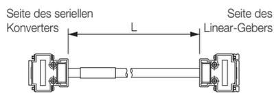
\* Bei Verwendung eines seriellen Konverters JZDP-J00□-□□□-E darf die Kabellänge 3 m nicht überschreiten.
