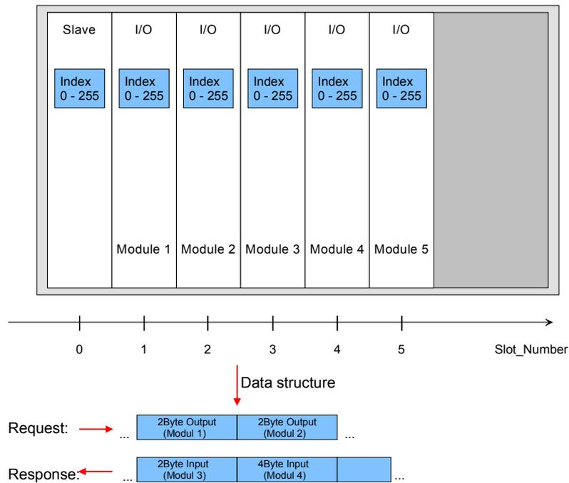
Jeder Datenblock kann bis zu 244Byte groß sein. Kompaktgeräte werden als eine Einheit von virtuellen Modulen betrachtet. Auch hier gilt die Adressierung mit Slot\_Number und Index. Durch die Längenangabe im Lese- bzw. Schreib-Befehl können auch nur Teile eines Datenblocks gelesen bzw. geschrieben werden.
