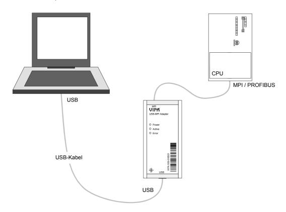
Hardware-Voraussetzungen Für den Einsatz des PC-AG-Adapters ist ein PC erforderlich, der eine USB-A-Schnittstelle besitzt.
