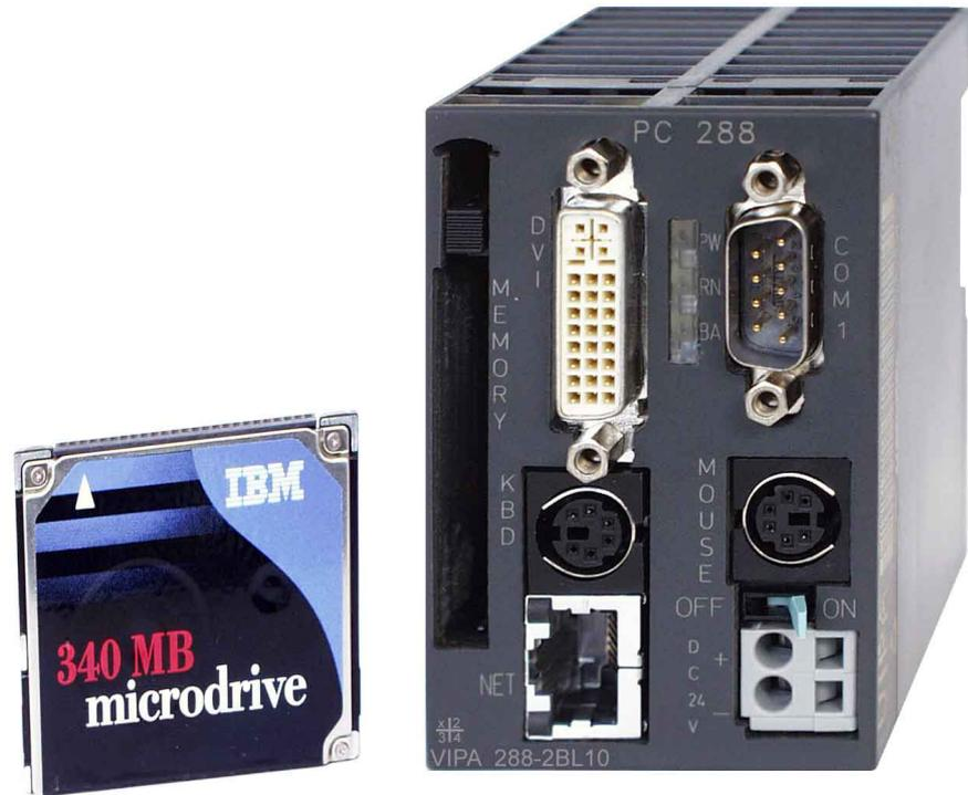
Der PC 288 ist ein vollwertiger 486DX-PC. Hiermit lassen sich zentrale und dezentrale Steuerungsaufgaben lösen.
