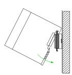
Setzen Sie das zu steckende Modul von oben in einem Winkel von ca. 45 Grad auf die Profilschiene und drehen Sie das Modul nach unten, bis es hörbar auf der Profilschiene einrastet. Nur bei eingerasteten Modulen ist eine Verbindung zum Rückwandbus sichergestellt.
