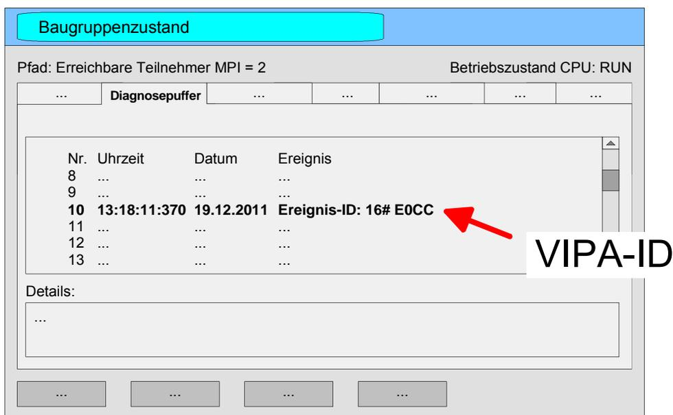
Für die Diagnose ist der Betriebszustand der CPU irrelevant. Es können maximal 100 Diagnoseeinträge in der CPU gespeichert werden. Auf der Folgeseite finden Sie eine Übersicht der VIPA-spezifischen Ereignis-IDs.
