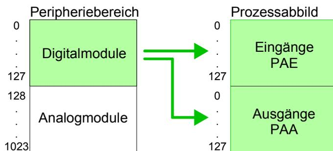
Nach jedem Zyklusdurchlauf wird das Prozessabbild automatisch aktualisiert.
