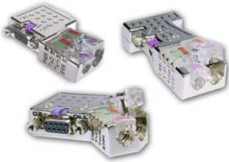
In Systemen mit mehr als zwei Stationen werden alle Teilnehmer parallel verdrahtet. Hierzu ist das Buskabel unterbrechungsfrei durchzuschleifen. Unter der Best.-Nr. VIPA 972-0DP10 erhalten Sie von VIPA den Stecker "EasyConn". Dies ist ein Busanschlussstecker mit zuschaltbarem Abschlusswiderstand und integrierter Busdiagnose.
