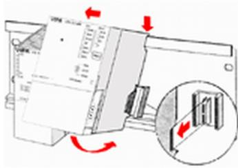
5. ➤ Hängen Sie die Spannungsversorgung ein und schieben Sie diese nach links bis an den Erdungsbolzen der Profilschiene.
