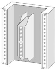
Für die Kommunikation der Module untereinander wird beim System 300S ein Rückwandbus-Verbinder eingesetzt. Die Rückwandbus-Verbinder sind im Lieferumfang der Peripherie-Module enthalten und werden vor der Montage von hinten an das Modul gesteckt.
