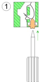
1. ➔ Zum Verdrahten drücken Sie mit einem geeigneten Schraubendreher, wie in der Abbildung gezeigt, die Verriegelung senkrecht nach innen und halten Sie den Schraubendreher in dieser Position.
