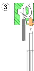
3. ➔ Durch Entfernen des Schraubendrehers wird der Draht über einen Federkontakt sicher mit dem Steckverbinder verbunden.
