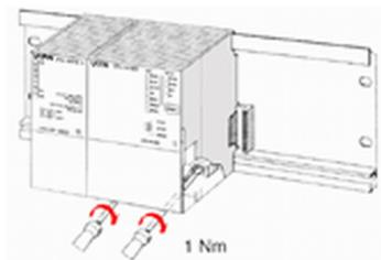
9. ➤ Klappen Sie die CPU nach unten und schrauben Sie die CPU wie gezeigt fest.
