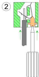
2. ➔ Führen Sie durch die runde Öffnung Ihren abisolierten Draht ein. Sie können Drähte mit einem Querschnitt von 0,08mm<sup>2</sup> bis 2,5mm<sup>2</sup> anschließen.
