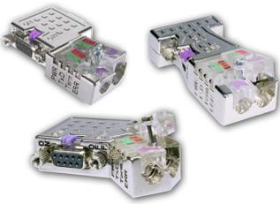
In PROFIBUS werden alle Teilnehmer parallel verdrahtet. Hierzu ist das Buskabel durchzuschleifen. Unter der Best.-Nr. 972-ODP10 erhalten Sie von Yaskawa den Stecker "EasyConn". Dies ist ein Busanschlussstecker mit zuschaltbarem Abschlusswiderstand und integrierter Busdiagnose.
