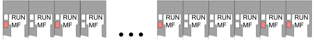
**Verhalten:** Nach dem Einschalten bleibt an jedem Modul die RUN-LED aus und es leuchtet sporadisch die MF-LED.
