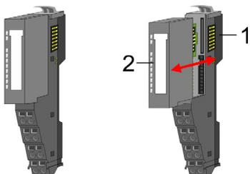
Jedes Peripherie-Modul besteht aus einem *Terminal-* und einem *Elektronik-Modul*.
