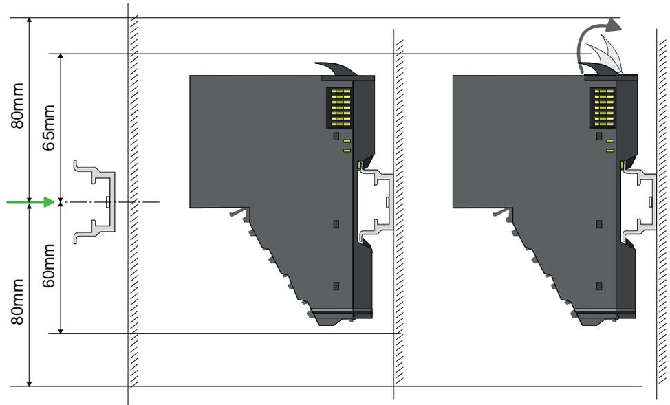
1. ➔ Montieren Sie die Profilschiene. Bitte beachten Sie, dass Sie von der Mitte der Profilschiene nach oben einen Montageabstand von mindestens 80mm und nach unten 80mm einhalten.
