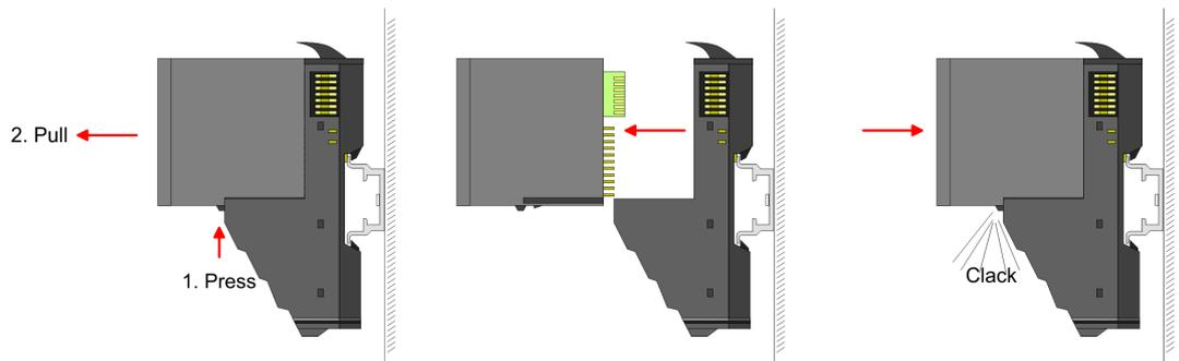
2. → Zum Austausch eines Elektronik-Moduls können Sie das Elektronik-Modul, nach Betätigung der Entriegelung an der Unterseite, nach vorne abziehen.
