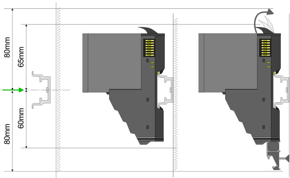
1. ➤ Montieren Sie die Profilschiene. Bitte beachten Sie, dass Sie von der Mitte der Profilschiene nach oben einen Montageabstand von mindestens 80mm und nach unten von 60mm bzw. 80mm bei Verwendung von Schirmschienen-Trägern einhalten.
