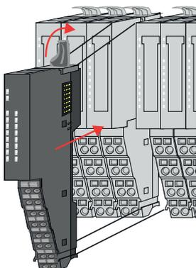
6. ➤ Stecken Sie das zu montierende Modul in die Lücke zwischen die beiden Module und schieben Sie das Modul, geführt durch die Führungsleisten auf beiden Seiten, auf die Profilschiene.
