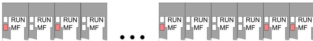
**Verhalten:** Nach dem Einschalten bleibt an jedem Modul die RUN-LED aus und es leuchtet sporadisch die MF-LED.
