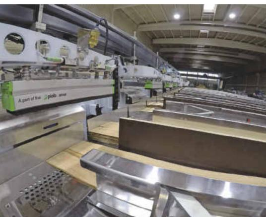
Das sensible Handling einzelner Furnierblätter erfordert eine filigran justierbare Vakuumtechnik. Erst mit einer komplexen Kombination aus Flächengreifer, Strömungsventilen, Durchflussbegrenzung, integriertem Hochleistungsejektor und einem Zwischenblasen im Prozess haben es die
