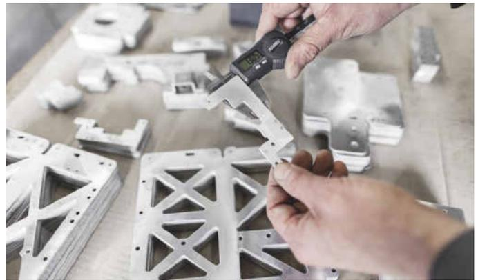
*Präzise auf den Punkt gebracht – mit einer Genauigkeit von  $\pm 0,1$  mm erzielt die Anlage gute Schneidergebnisse.*
