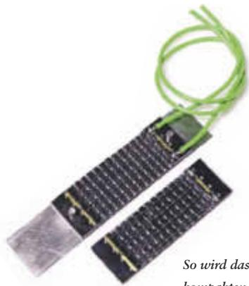
So wird das Aktorikmodul zum kompakten, flexibel gestalteten Biegeaktor (oben) Bild: CompActive
