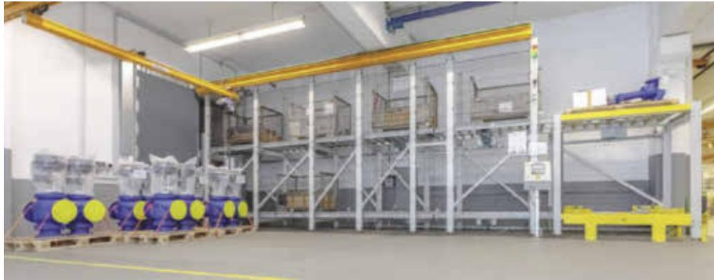
Im Erdgeschoss erfolgen die Aufgabe und Abnahme der Paletten und Gitterboxen auf die Rollenbahnen, die gleichsam als Pufferflächen dienen, um kurzfristige Spitzen abzufangen.
