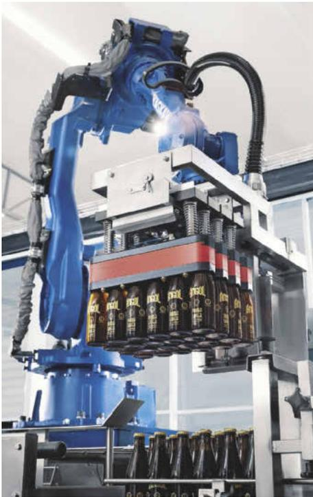
Yaskawa hat sich mit einer Komplettlösung für das roboterbasierte Handling von Flaschen beworben.
