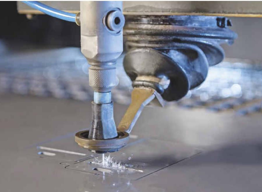
25 % mehr Leistungsdichte, 40 % höhere Schneidgeschwindigkeit, dabei umweltschonend und automatisiert: Mit der neuen EcoCut bearbeitet Stimpfle Edelstahl, Aluminium und Granit im fliegenden Wechsel. Bilder: STM Waterjet
