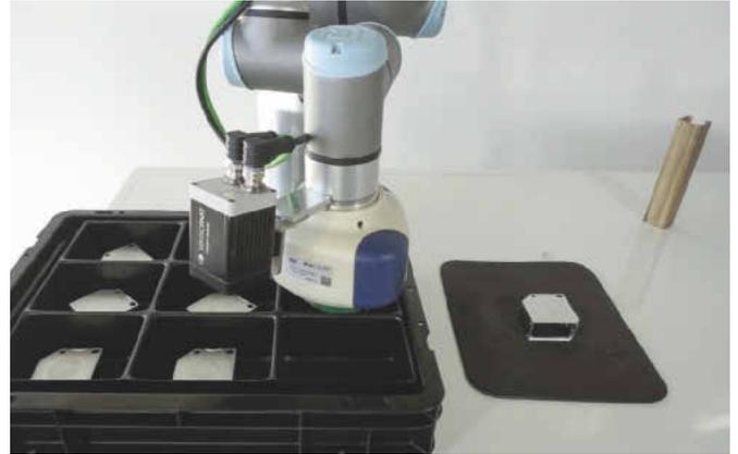
Das Sensorsystem Visor Robotic ist ein optischer Sensor, der speziell für die Roboteransteuerung entwickelt wurde. Mit dem Kamerasystem lassen sich Aufgaben wie Kalibrierung und Objektdetektion inklusive Datenübergabe an den Roboter elegant lösen. Mit den vorhandenen Kalibriermethoden lassen sich die internen und externen Systemparameter bestimmen. Die gewonnenen Daten kann der Roboter di-
